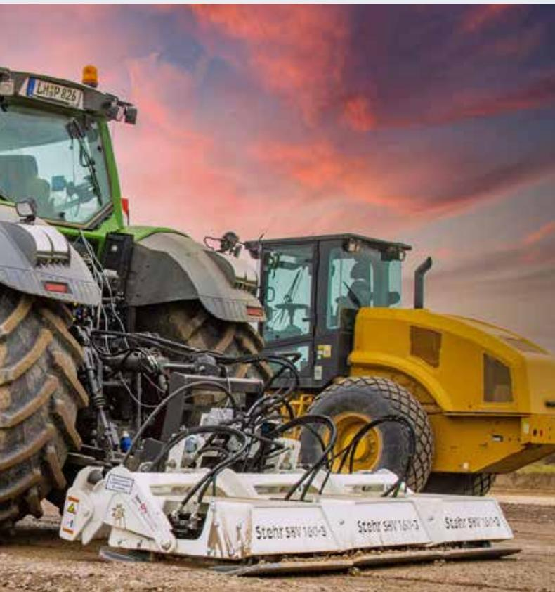
Räume zwischen den größeren Körnern wandern. Durch zusätzlichen Druck, der durch Belastung auf das nicht schwingende Oberteil elektronisch geregelt wird, lässt sich die Flächenpressung erhöhen, und es entsteht eine wesentlich homogenere Oberfläche.
