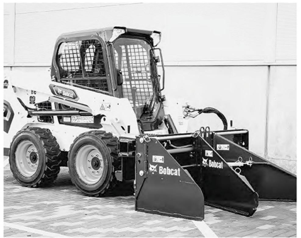
Der Bobcat-Straßenfertiger ist als Anbaugerät für alle Bobcat-Kompaktlader ab dem Modell S450 bis einschließlich S850/H, alle Bobcat-Kompaktraupenlader einschließlich T450, T590/H, T650/H, T770/H und T870/H sowie den Kompaktlader A770/H mit Allradlenkung zugelassen.
