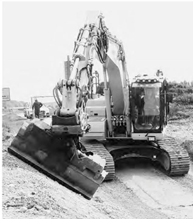
Der neue Komatsu-Bagger PC 210LCi-11 der Josef Hogger Tiefbau e. K. ist werkseitig mit der Technologie der intelligenten Maschinensteuerung ausgestattet.
