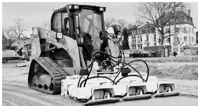
Für Erdbauarbeiten nutzte die Firma Schnell patentierte Stehr-Plattenverdichter. FOTO: SCHNELL
