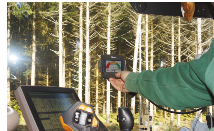
Das Stehr Verdichtungsmesssystem SCC zeigt mit einer übersichtlichen grafischen Darstellung den Verdichtungsgrad. Der Fahrer kann dank dieser Unterstützung unnötige oder zu langsame Überfahrten vermeiden.
