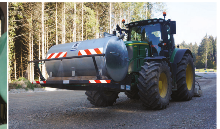
Ebenfalls eine Stehr-Entwicklung: 2.000 l fasst der Berieselungstank. Eine fein regelbare Pumpe sorgt stets für die richtige Menge und Breite der Berieselung.
