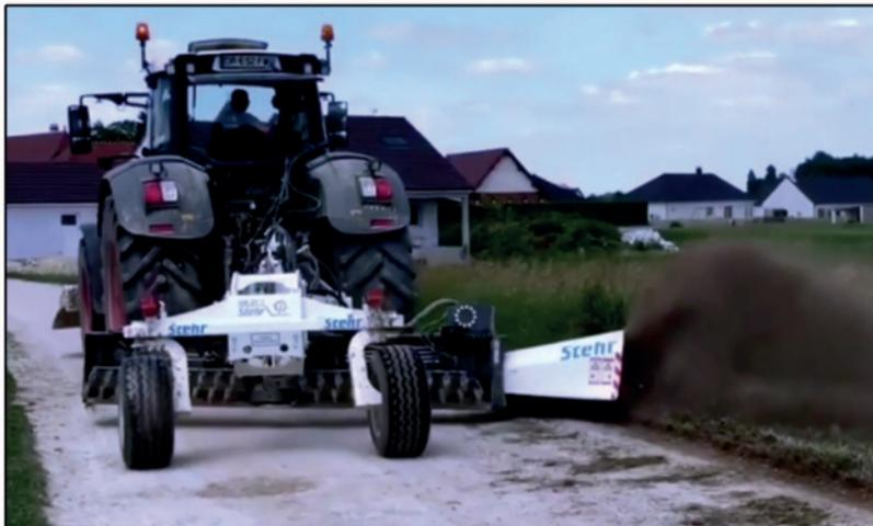
Der Anbaugrader **SUG 35-T** ist ab Werk schon vorbereitet für die Bankettfräse und kann auch jederzeit nachgerüstet werden.
