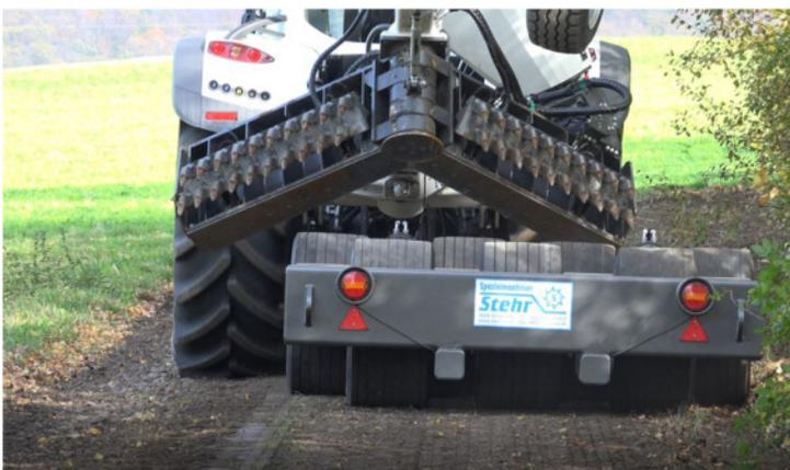
Verdichtung durch die Gummiradwalze mit sehr hoher Geschwindigkeit. Zusätzlich um 30° in der Breite seitlich verschiebbar über die Traktorspur.
