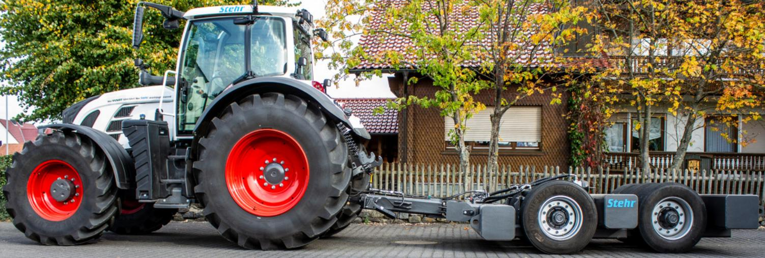
Sieben gleichgroße, versetzt angebrachte, profillose Räder erreichen einen statischen Bodendruck von 1850 kg bis zu 4300 kg pro Rad!!
