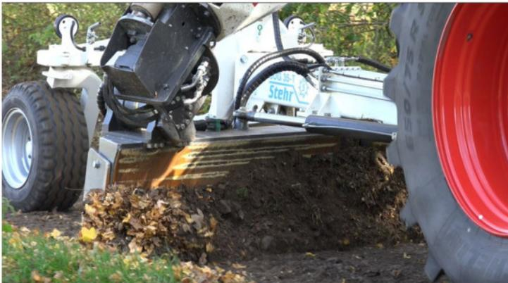
Der Wegekörper wird mit einem Dachprofil durch das patentierte Stehr V-Schild planiert und Unebenheiten egalisiert.
