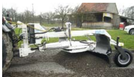
Der Stehr-Anbaugrader beherrscht ebenso Feinarbeiten mit Laser-, Ultraschall- oder GPS-Steuerung sowie grobes Planieren.
